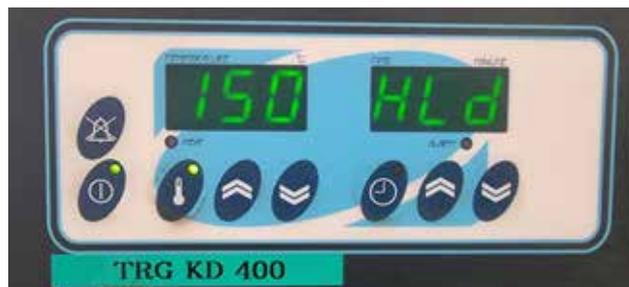
La prova verifica la capacità di un tubo di mantenere quanto più possibile inalterata la propria lunghezza se sottoposto a variazioni e sbalzi termici; nel caso di TriPPlo+, verifica che non subentrino distacchi o alterazioni di aspetto e di geometria delle singole pareti che lo compongono. La prova si svolge a 150 °C all'interno di una stufa, secondo EN ISO 2505.
