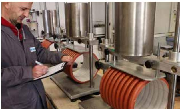
Per mezzo di un test di schiacciamento di lunga durata (1.008 ore), esperito secondo UNI EN ISO 9967, si ricava una valutazione del comportamento a lungo termine del tubo, una volta che esso sia stato installato ed interrato in trincea.
