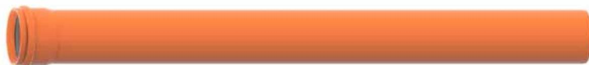
Tubo in polipropilene alto modulo (PPHM) con parete compatta mono-strato; giunzione a bicchiere anellato con guarnizione elastomerica pre-inserita, orientata secondo la direzione del flusso, dotata di anello rigido di fissaggio. Normalizzato sul diametro esterno DN/OD.
