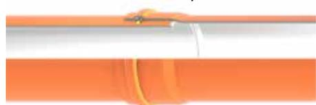
L'immagine sottostante, che è tratta dalla Fig. 16 di pagina 24, illustra bene quanto sopra dettagliato: si può osservare la sovrapposizione del codolo e del bicchiere, entrambi a tre strati. Se ciò è scontato per il codolo, va invece rimarcato per il bicchiere, di cui, durante la termoformatura, viene accuratamente mantenuta la struttura a tre strati. In tal modo il bicchiere, come già il codolo, mantiene le proprietà di rigidità anulare (SN) della barra, ed esse, nella giunzione, si sommano.
