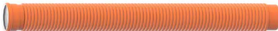
Tubo in polipropilene alto modulo (PPHM) con doppia parete strutturata, liscia internamente, corrugata esternamente; giunzione a bicchiere anellato con guarnizione elastomerica pre-inserita, orientata secondo la direzione del flusso. Normalizzato sul diametro esterno DN/OD.
