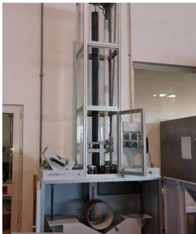
*Il metodo EN 1411 stabilisce le severe condizioni di questo test, che è una prova di resistenza all'urto svolta con provini condizionati a -10 °C e con masse battenti fino a 12,5 kg lasciate cadere da altezze che arrivano ad un massimo di 2 m. In tal modo si verifica la capacità del manufatto di resistere, anche in condizioni estreme, ad urti e sollecitazioni improvvise che si possono verificare durante l'installazione o la movimentazione in cantiere.*
