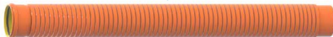
Tubo in polipropilene alto modulo (PPHM) con doppia parete strutturata, liscia internamente, corrugata esternamente; giunzione a bicchiere anellato con guarnizione elastomerica pre-inserita, orientata secondo la direzione del flusso. Normalizzato sul diametro interno DN/ID.
