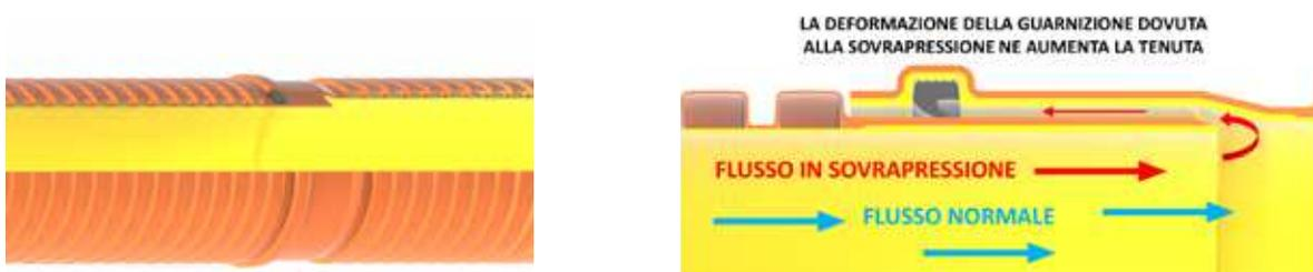
Fig. 18 - Nel caso di Kingcor, la sezione mostra anche due delle corrugazioni, visibili a sinistra
