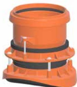
Innesto tecnico universale ad alta tenuta idraulica; corpo, flange e sella in polipropilene (PP), parti in gomma in EPDM, viterie in acciaio. Compatibile con tubi di ogni materiale.
