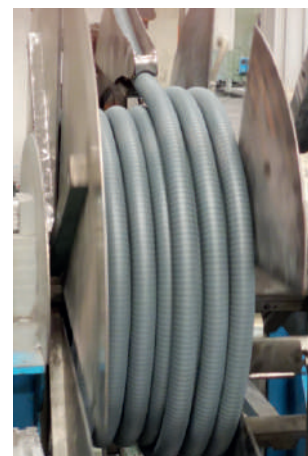
A sinistra: matassa di Corrugar blu da 50 m (v. tab. 12) A destra: un ASPO (avvolgitore automatico) in funzione durante la fabbricazione di Corrugar grigio (v. tab. 12); la matassa, dotata di tirafilo in poliestere e manicotto, viene poi reggetata e imballata
